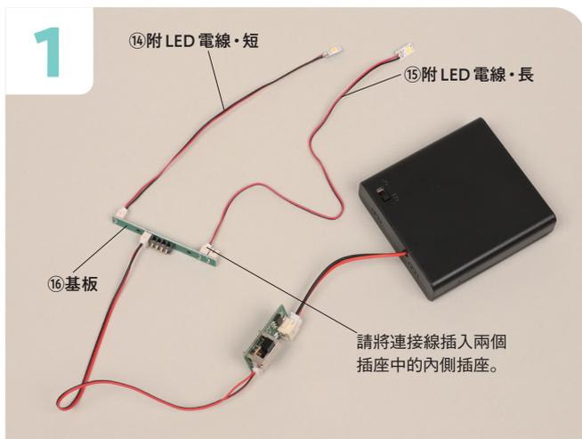
將⑭附 LED 電線・短、⑮附 LED 電線・長以及電池盒等連接到⑯基板上，如照片所示。
