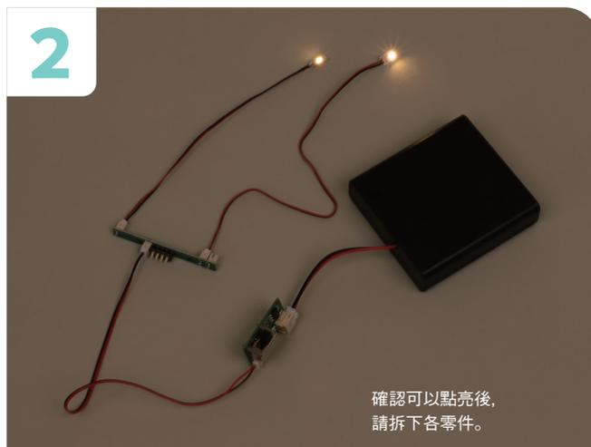
將電池盒的開關設置為「ON」，打開電池盒用基板的開關，確認 LED 可以點亮。
