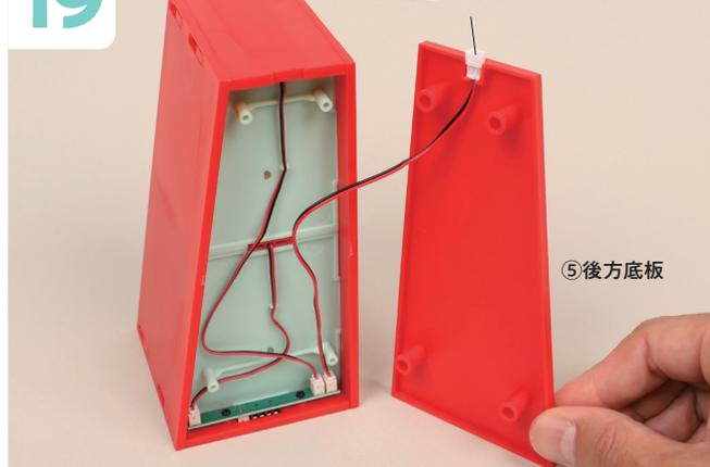
將⑤後方底板靠近盒子的後方，將連接線插頭插入上方的凹槽。
