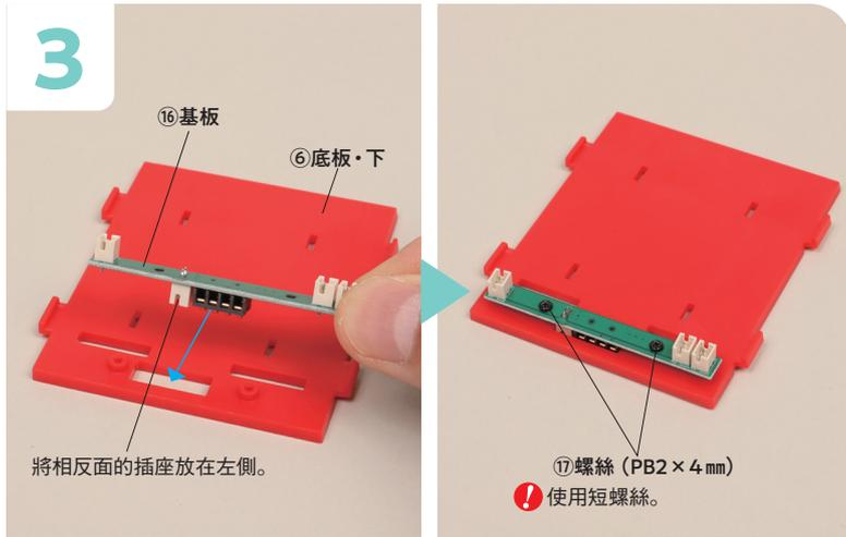
將⑯基板組裝在⑥底板·下,如同照片所示,使用兩根⑰螺絲 (PB2 × 4 mm) 鎖緊固定。
