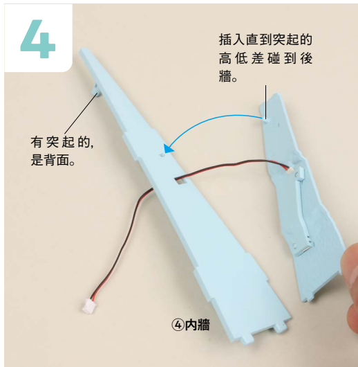
在④內牆的正面將 3 的背景組裝起來。將電線前端的連結器穿過方形的洞, 邊拉電線將背景的突起插入內牆的洞。
