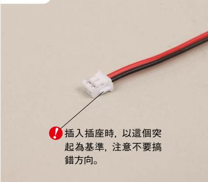
確認⑩附 LED 電線·短及⑪附 LED 電線·長尖端的連結器。正反的形狀不一樣。以側面的突起為基準, 注意不要搞錯方向。
