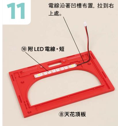
撕下⑩附 LED 電線·短背面的藍色膠膜, 對好⑧天花頂板的凹陷處黏上。
