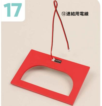
組裝到這步驟, 確認 LED 是否確實亮燈。首先, 在天花頂板的另一側正面的插座, 插入⑳連結用電線的連結器。
